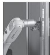
Испытания на цикличность
